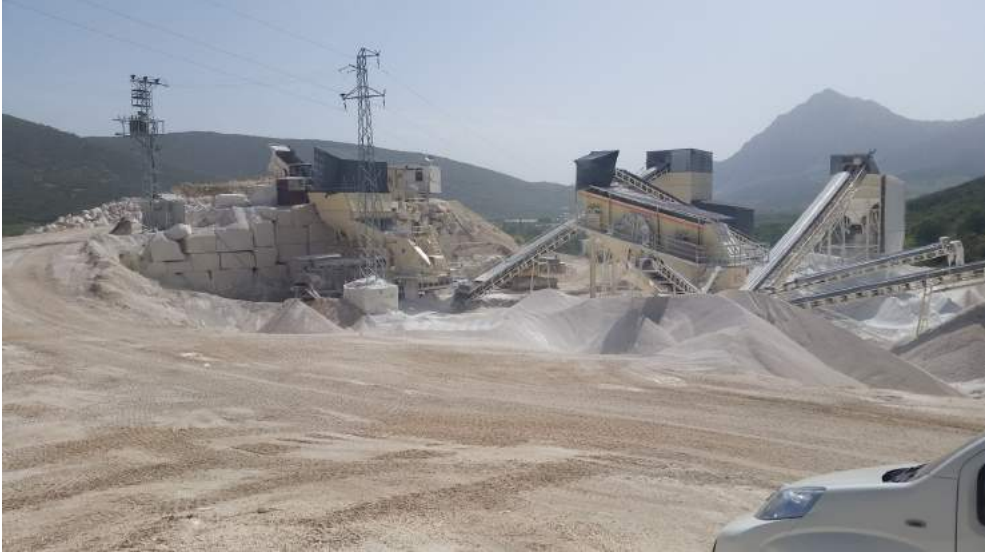
Şekil 12.1. Doğal taş artıklarından beton agregası üretimi
