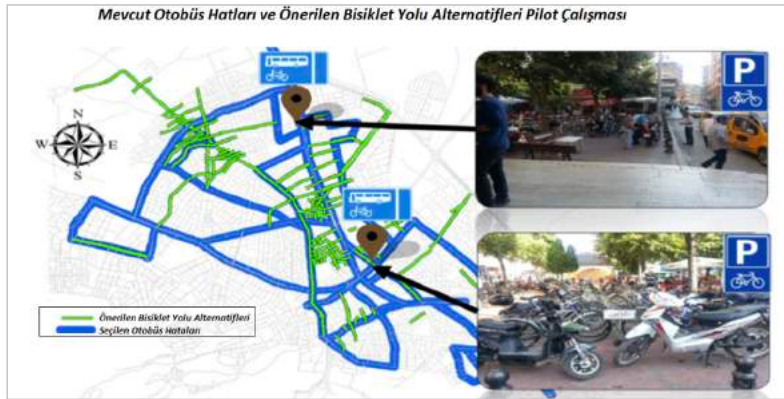
Şekil 3.27. Seçilen kesimdeki otobüs linki ve düzenlenmesi gereken bisiklet yolları ile bisiklet park yerleri örneği (Saphioğlu ve Aydın, 2018)
